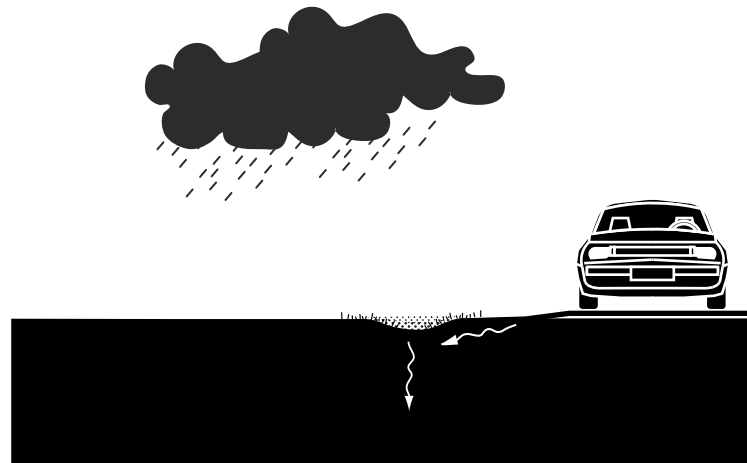
Het regenwater van de wegen wordt geïnfiltreerd / afgevoerd via kleine greppels langs de weg.
