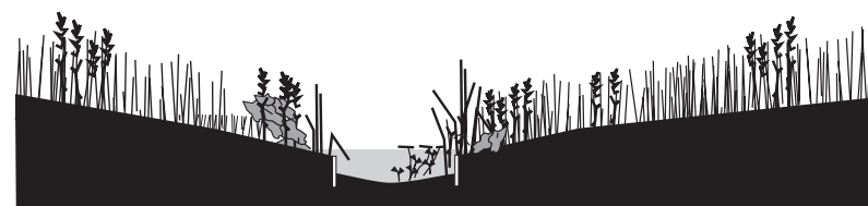
Doorsnede 1 toekomstbeeld; verwijderen / inkorten walbeschoeiing
