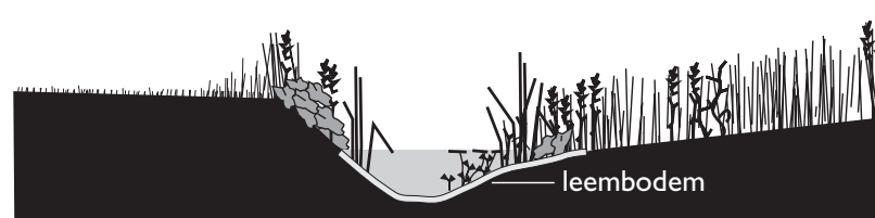
Doorsnede 2 toekomstbeeld; aanpassing vijver
