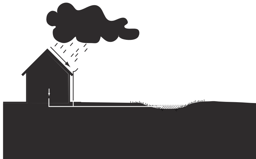
Infiltratie regenwater door middel van landschappelijke laagte
