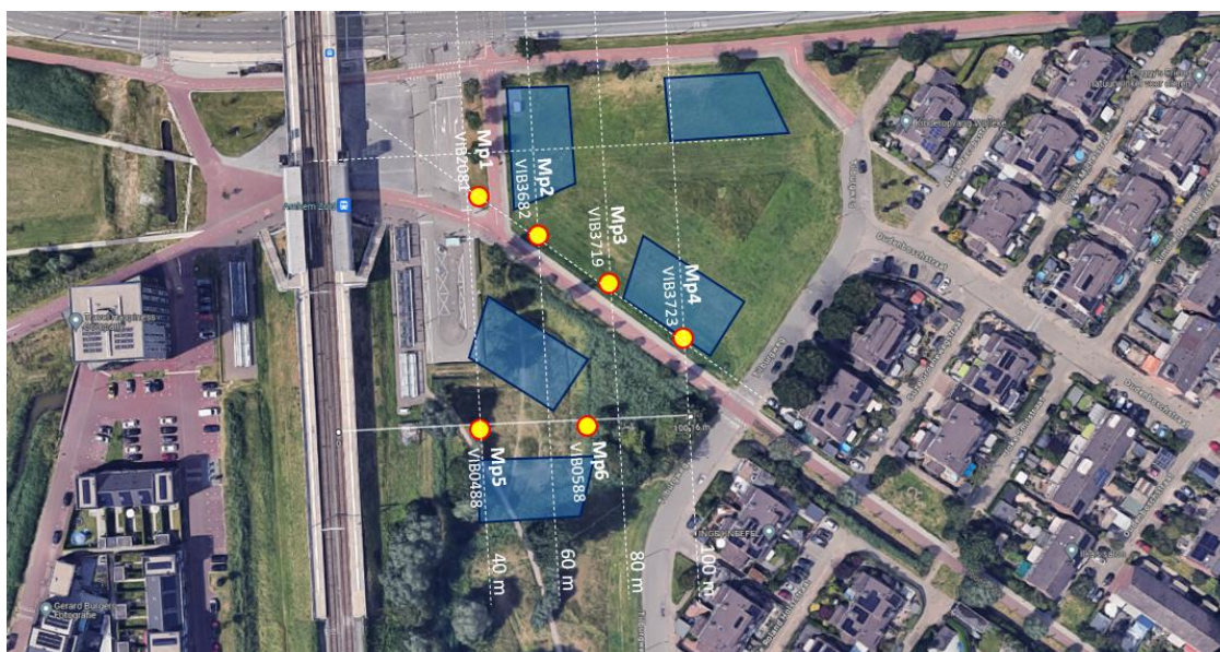
figuur 3: meetposities, MP1 t/m MP6 in de bodem op verschillende afstand van het spoor
